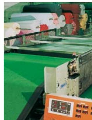
Крестовкладчик при производстве нетканых материалов. Высокая скорость производства и ускорения массы при поперечной раскладке прочеса непосредственно между двумя конвейерными лентами предъявляют к таким лентам очень высокие требования.
