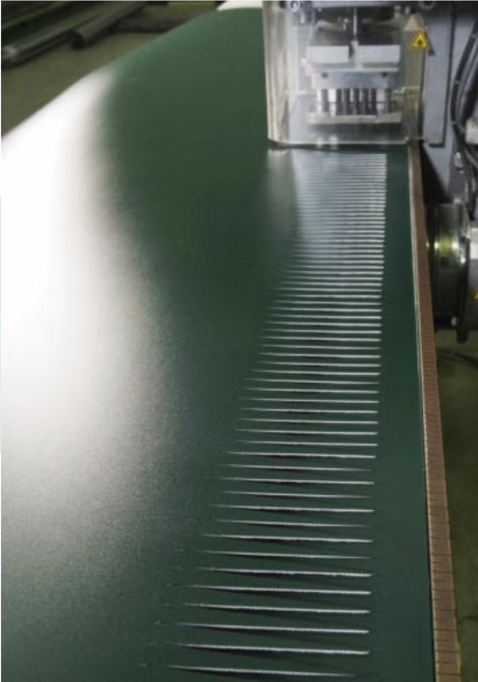
CHIUSURA AD ANELLO DEI NASTRI: LA FUSTELLATURA CONVEYOR BELTS ENDLESS MAKING: FINGER CUTTER
