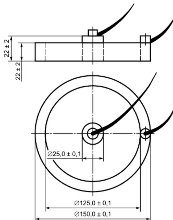
Рисунок В.1 - Схема установки электродов
