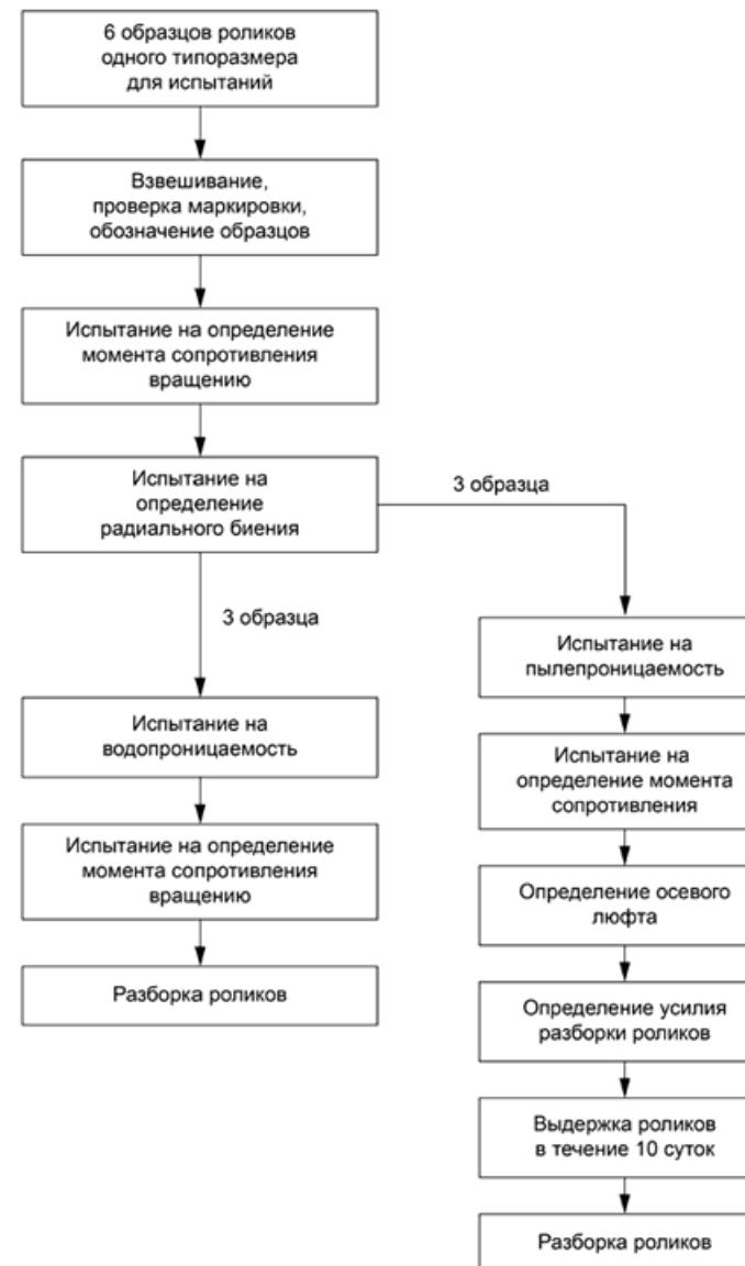
Рисунок 2 - Схема проведения испытаний
