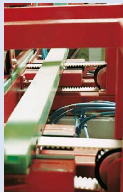
Транспортировка автостекел синхронно движущимися ремнями. Накладки на спинке ремня деликатно удерживают перемещаемый предмет и исключают проскальзывание.
