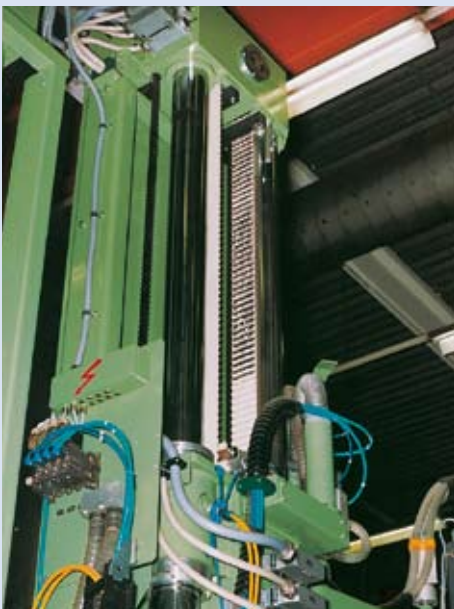
Зубчатые ремни Siegling Proposition в механизме вертикального перемещения промышленного робота
