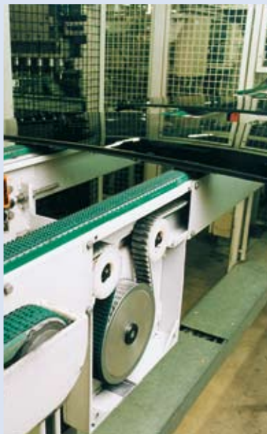
Транспортировка автостекел синхронно движущимися ремнями. Накладки на спинке ремня деликатно удерживают перемещаемый предмет и исключают проскальзывание.
